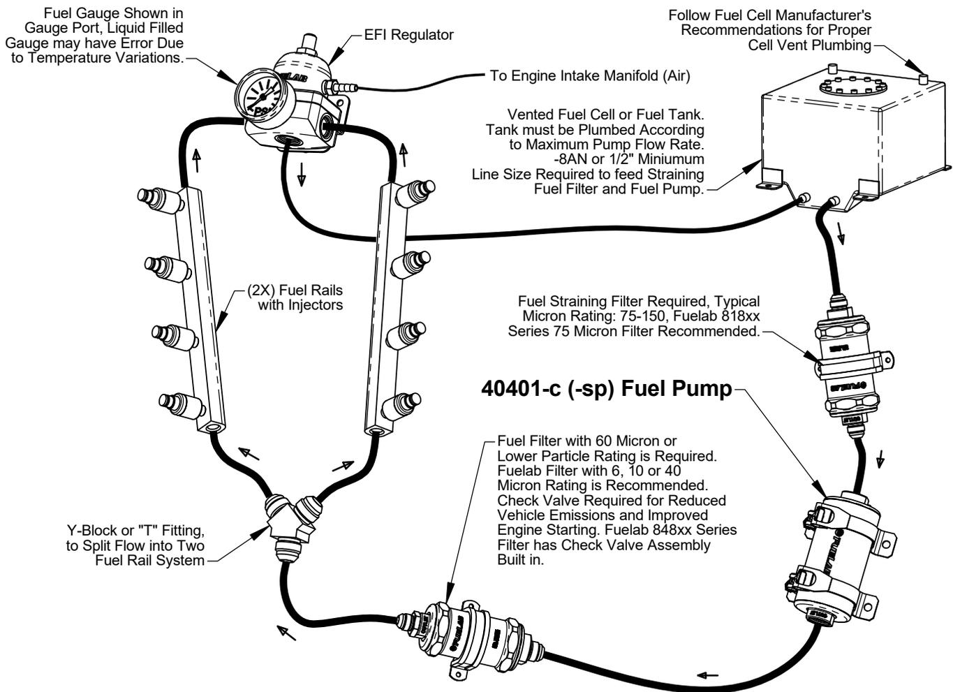
Besonderer Hinweis: Der Einsatz in Vergasersystemen erfordert einen Bypass-Rücklauf oder ein Überdruckventil. Die Kraftstoffpumpe darf nicht mit „totem Kopf“ betrieben werden.
