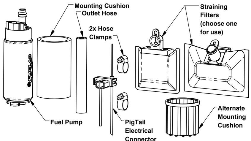
**WARNUNG!** Diese Kraftstoffpumpe hat eine hohe Durchflussleistung und verbraucht auch eine höhere Stromaufnahme als normal. Die Kraftstoffpumpenverkabelung des Fahrzeugs ist möglicherweise nicht ausreichend, um diese Kraftstoffpumpe sicher zu betreiben, und Spannungsabfälle durch ihre Verwendung beeinträchtigen die Durchflussleistung erheblich. Die Verwendung eines elektrischen Systems mit Hochstromrelais aus dem Zubehörmarkt wird dringend empfohlen.
