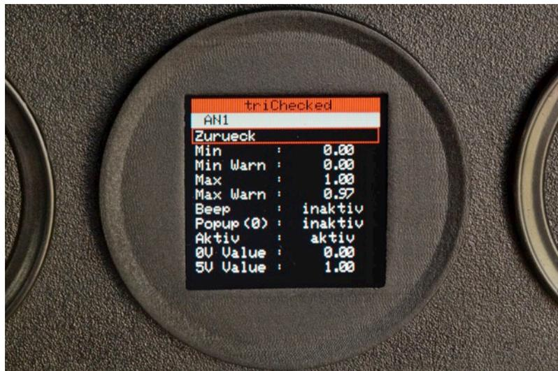
Zunächst muss man den Sensor aktivieren unter dem Punkt „Aktiv“. Erst dann werden auch Werte angezeigt. Nun kann man optional unter 0V und unter 5V den entsprechenden Wert angeben. Entweder steht dieser im Datenblatt des Sensors oder man muss diesen händisch ermitteln.
