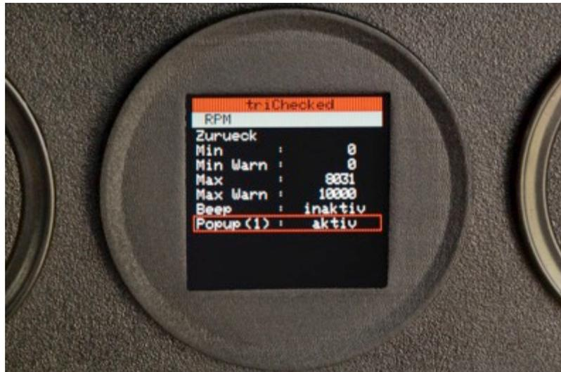
Es können maximal 6 Sensoren ausgewählt werden. Für weitere Sensoren ist die Auswahl dann gesperrt. Das hat Gründe der Übersichtlichkeit, da die Werte gleichzeitig überschritten werden können.
