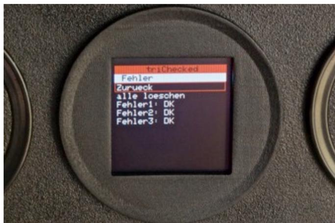
Wählt man den Fehler aus und bestätigt, sieht man alle Werte zu zum Zeitpunkt des Überschreitens des Schwellwertes aktuell waren. Der überschrittene Wert ist ROT markiert. Mittels Knopfdruck gelangt man wieder zur Fehlerübersicht.
