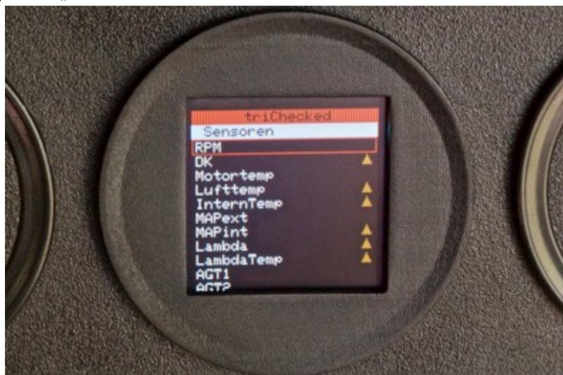
Hier sind alle abgefragten Sensoren einsehbar und ob diese bereits einen Warnwert überschritten haben, markiert durch ein Dreieck. Hier kann man nun einen einzelnen Sensor auswählen (z.B. Drehzahl – RPM):
