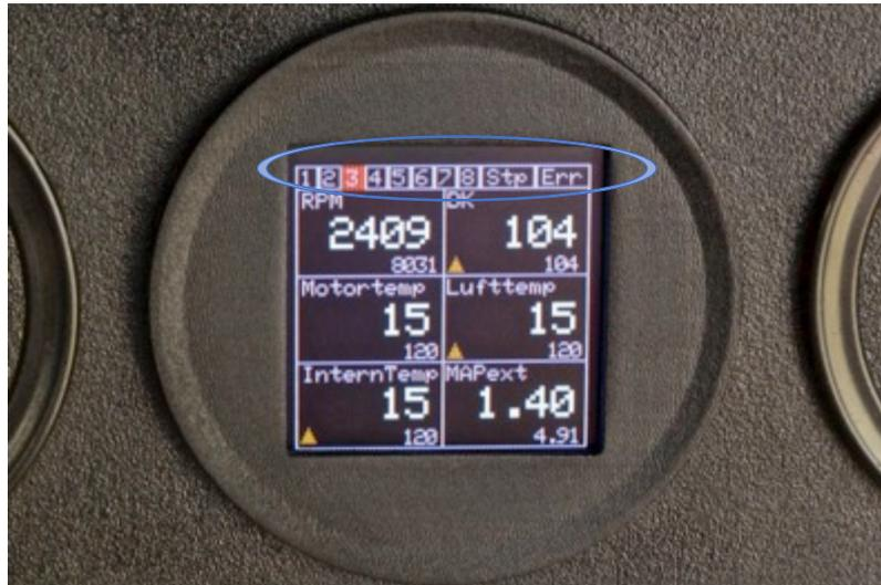
Unterbricht man die derzeitige Darstellung mittels eines Klicks auf den Button, so erscheint im oberen Bereich eine Leiste. Dort sind zunächst die Ansichten 1 bis 8 dargestellt, welche man auswählt, mittels Buttonklick bestätigt und so in die entsprechende Ansicht springt. Die rot hinterlegte Zahl (im Bild „3“) ist die derzeit ausgewählte Ansicht. „Stp“ steht für Setup und führt zu den Einstellungen des CANchecked Displays. „Err“ zeigt den aktuellen Fehlerspeicher an.
