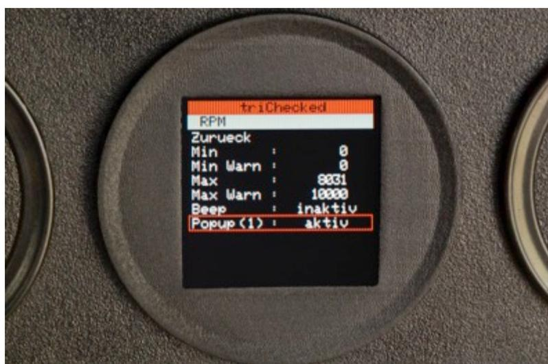
Man kann für jeden Sensor den unteren („Min Warn“) und oberen („Max Warn“) Schwellwert angeben, wo eine Warnung dargestellt werden soll. Unter „Min“ bzw. „Max“ sind die aufgetretenen Minimal- und Maximalwerte abgespeichert und können mittels Buttonklick gelöscht werden. Diese löschen sich ebenso bei einem Neustart.
