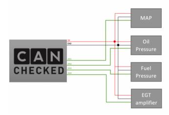
Möchte man NTC Elemente betreiben (Temperatursensoren), so nutzt man am besten AIN5 und AIN6. Beide haben bereits 1K Widerstände als Pullup installiert. Also verbindet man Masse des Sensors mit Masse des MCE08 und der Messeingang mit der anderen Seite des Sensors.
